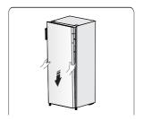
9 .Montieren Sie das obere Scharnier und setzen Sie die Achse des oberen Scharniers in die Bohrung an der Oberseite der Tür ein. Prüfen und korrigieren Sie ggf. die Position der Tür (dabei die Tür mit der Hand abstützen) und befestigen Sie dann das obere Scharnier mit den Blechschrauben.
