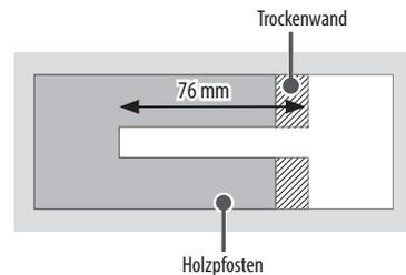
Verwenden Sie einen Ø 4 mm Bohrkopf für Holz und eine Bohrtiefe von 76 mm. (Entfernen Sie die Bohrrückstände aus den Löchern.)
