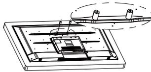
Wenn Sie beim 40-Zoll-Modell den Fernseher an der Wand montieren müssen, müssen Sie die Wandhalterung (2 Stück) manuell installieren und dann mit dem nächsten Installationsschritt fortfahren.
