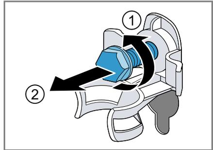
3. Die Netzanschlussleitung von der Halterung entfernen.
