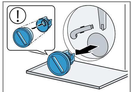
Der Pumpendeckel besteht aus zwei Bauteilen die zur Reinigung auseinandgebaut werden können.
