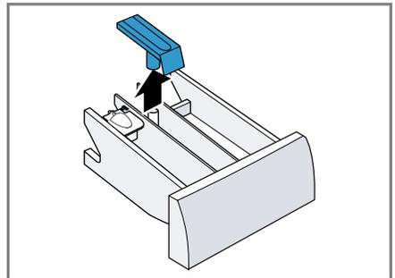
4. Die Waschmittelschublade und den Einsatz mit Wasser und Bürste reinigen und abtrocknen.
